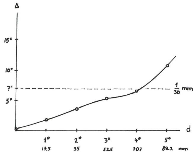
Ergebnis: Bis zum Bilddurchmesser von  $4^\circ$  bleiben die Sternbildchen kleiner als  $7''$ , das Bildfeld ist allerdings jetzt elliptisch-konvex zum Spiegel gekrümmmt mit einem praktisch verwendbaren Krümmungsradius von 735 mm.
