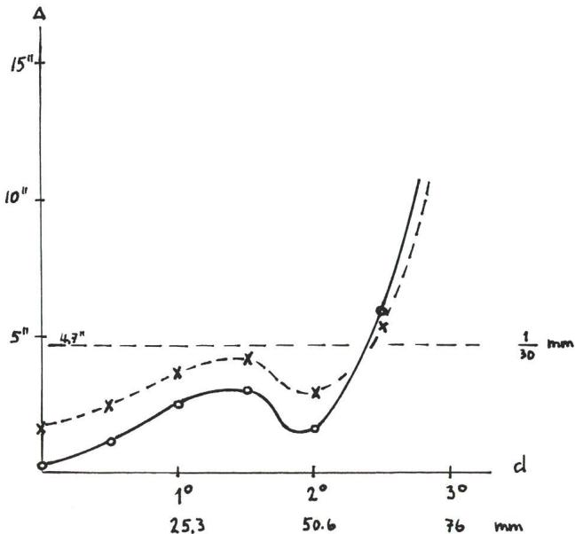
Ergebnis: Innerhalb eines Bildfeldes von  $2^\circ$  Durchmesser bleiben die Sternbildchen kleiner als  $3''$  (violett  $4''$ ), nachher wachsen sie aber sehr rasch an.
