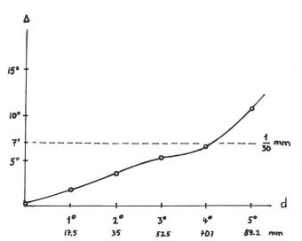
Ergebnis: Bis zum Bilddurchmesser von 4° bleiben die Sternbildchen kleiner als 7", das Bildfeld ist allerdings jetzt elliptisch-konvex zum Spiegel gekrümmt mit einem praktisch verwendbaren Krümmungsradius von 735 mm.
