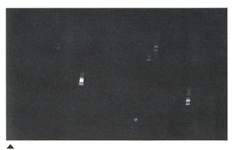
5. Hier wurde mit einem 300 mm-Teleobjektiv (1:4) durch ein 30°-Flintprisma hindurch photographiert. Es entstehen hübsche Sternspektren (am hellsten Beteigeuze, schwächer Bellatrix), an denen einige Absorptionslinien erkennbar werden und eine grobe Spektralklassifikation ermöglichen. Die Erdrotation wurde zur seitlichen Aufweitung der fadenförmigen Spektren verwendet, d.h. die Aufnahme wurde absichtlich nicht nachgeführt (Kodachrome 200).
