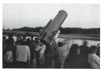
1. Das 50-cm-Spiegelteleskop der Sternwarte Bülach ist wegen seiner massiven Montierung und genau laufenden Nachführung sehr gut für Astrophotographie geeignet. Die Möglichkeit, vom Cassegrainmodus auf Newton umzustellen, führt zur Diskussion der verschiedenen Öffnungsverhältnisse und ihrer Bedeutung beim Photographieren.
