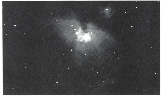
▲ 6. Orionnebel, 15 min auf Kodachrome 200 bei 50 cm/Brennweite 2.5 Meter, Nachführung mit "Off-axis-System". Das Bild wurde auf Kodachrome 25 umkopiert, um den Kontrast zu steigern. Weil die Nachführung nicht perfekt gelang (die Kursteilnehmer versuchten zum ersten Mal, den Stern auf dem Fadenkreuz zu halten), sind die helleren Sterne nicht punktförmig.
