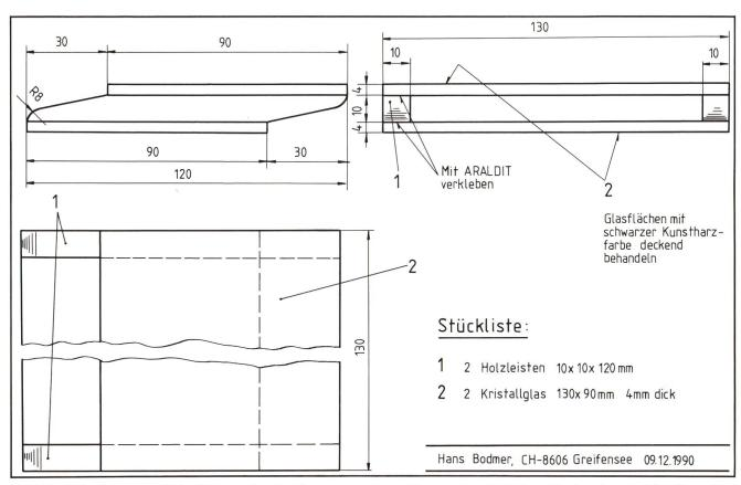
Zwei identische, 4 mm starke Kristallglasscheiben 9 x 13 cm werden mit zwei 9 mm starken Holzleisten 11 x 1 cm im parallelen Abstand von 1 cm und um 3 cm verschoben mit Zwei-Komponenten-Kleber seitlich miteinander verklebt. Die beiden äusseren Glasflächen werden mit einer schwarzen Kunstharzfarbe gut deckend bemalt.
