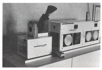
Bild 6: Vor dem Projektor ist der Fokussierschlitten mit dem aufgesetzten H-alpha-Filter montiert. Zwischen den zwei Kästen liegt die Tastatur, mit der die Bewegung des Nachführspiegels ferngesteuert wird.
