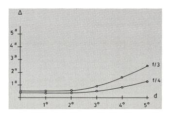
Ergebnis: Bis zur relativen Öffnung von f/3 bleiben die Sternbildchen im Bildfeld von 5° Durchmesser unter 2.5", bei f/4 unter 1.3". Das Bildfeld ist nun aber nicht mehr plan, sondern wie bei der Schmidtkamera konvex zum Spiegel gekrümmt. Der Krümmungsradius der Bildfläche ist gleich gross wie die Spiegelbrennweite, also in unserem Beispiel
