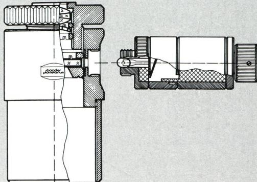
Dieses neu entwickelte, mit lasergeätztem Meßplättchen versehene orthoskopische Okular mit regelbarer Beleuchtung erschließt dem Astroamateur neue Arbeitsmöglichkeiten. Es läßt sich u. a. für folgende Aufgaben einsetzen:
