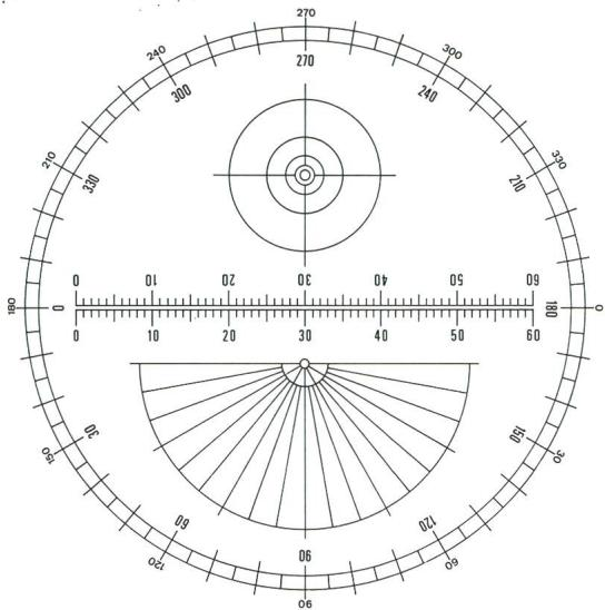
Vor 4 Jahren erschien in S. u. W. ein Bericht von P. Stättmayer über sein Kometen-Nachführokular (S. u. W. 8/9/85 S. 476 ff.). Wir fragten damals nach einem Entwurf für ein eigenes Fadenkreuzokular und Herr Stättmayer konstruierte für uns ein völlig neuartiges Meßfeldokular. Vom ersten Entwurf bis zum Abschluß der Erprobung sind fast 3 Jahre vergangen – die Mindestzeit, um ein ausgereiftes Produkt anbieten zu können.
