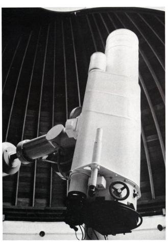
Bild I Der ZEISS Astrograf 400/2000 mm im Observatório do Capricórnio bei Campinas
