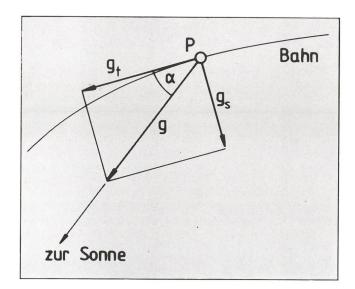
Abb. 1 Komponenten der Gravitationsbeschleunigung vertikal und tangential zur Bewegungrichtung des Planeten.
