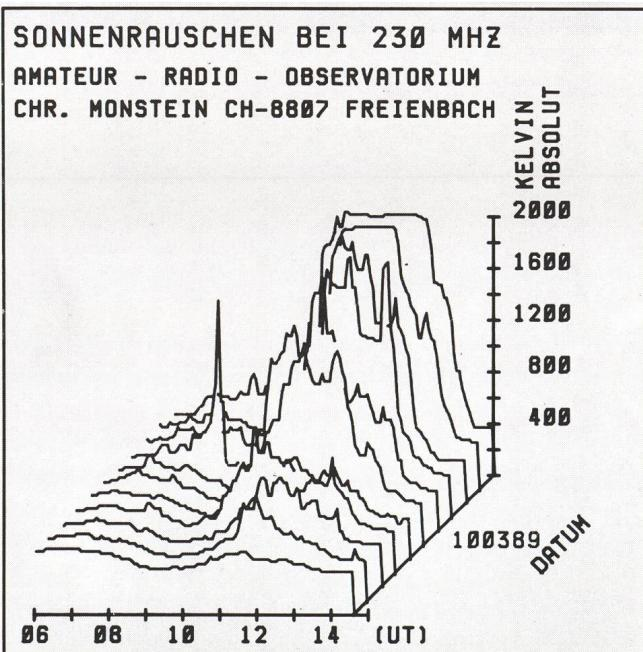
Auf der linken Seite ist die Übersicht vom 5.3.89 bis zum 15.3.89 in Schritten von einem Tag abgebildet. Ereignisse wie jenes vom 6.3.89 um 1510 sind elektronisch ausgefiltert, damit man die globale Entwicklung der Signalintensität bei 230MHz (Wellenlänge 1,3m) besser erkennen kann.
