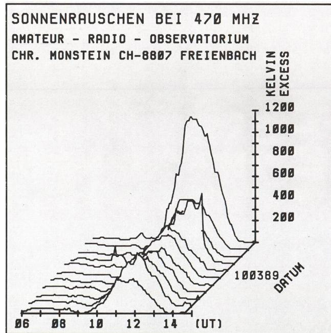
Dasselbe Datum, dieselben Zeiten wie Abbildung 1a, allerdings jetzt auf der Empfangsfrequenz 470MHz (Wellenlänge 64cm). Auch hier kann man am Morgen ganz schwach den abfallenden Teil der Milchstrasse erkennen und deutlicher als in 1a die Kulmination der Sonne um 1130 UT. Der grösste Rauschpegel wahr am 15.3.89 zu registrieren, mit Werten, welche die ruhige Sonne um Faktoren übertreffen.
