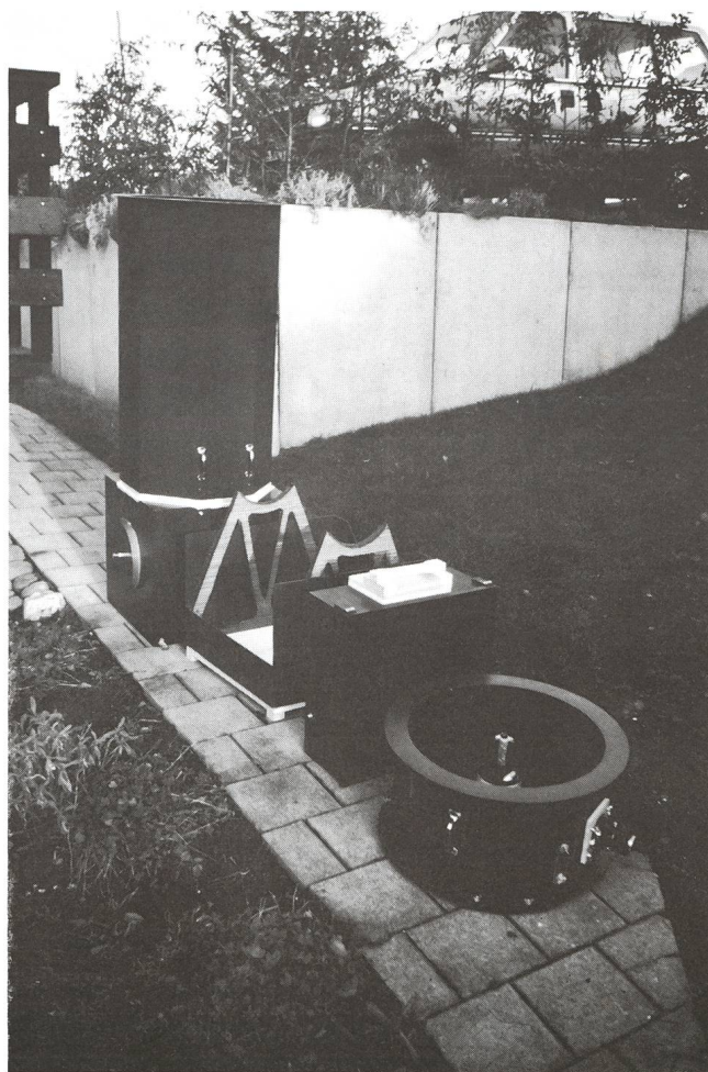
Das zerlegte Teleskop (von vorne nach hinten): Fangspiegelträger, Hauptspiegelkoffer mit geschlossenem Schieber, azimutale Montierung, Tubus. Der Tubus kann nach Entfernen der Handgriffe verkürzt werden, indem der achteckige in den viereckigen Teil hineingeschoben wird.
