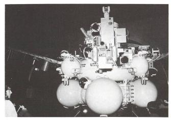
Die Phobosraumsonde aus den UdSSR wurde am 1. Februar in die Marsumlaufbahn eingebremst. Das Bild zeigt ein Modell der Sonde, deutlich zu erkennen ist unten die Bremstriebwerksektion mit den runden Kraftstofftanks. Das kleine schwarze Viereck am oberen linken Rand der Sonde ist das Schweizer Experiment IPHIR. Bild: Fröhlich/Archiv Schmidt
