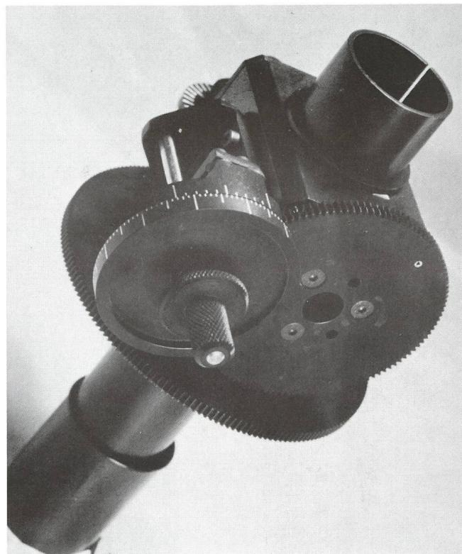
de la mesure de cette inclinaison la valeur de la distance angulaire des composantes d'un couple. De la mesure de l'angle de rotation de la lame lorsque les quatre images forment la figure décrite plus haut, on déduit l'angle de position. Le principe de ce micromètre et de son utilisation ont été exposés en détail par *Jean-Louis Agati et René-Georges Huret* (2).
