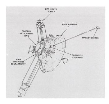
Bild 1: Skizze der Pioneer Raumsonde. Kernstück der Raumsonde ist die grosse Parabolantenne für den Funkverkehr zur Erde. Skizze: NASA/Archiv Schmidt
