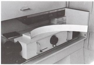
Bild 5. Blick auf die optische Bank mit dem den Spalt tragenden Holzkästchen und der Projektionswand
