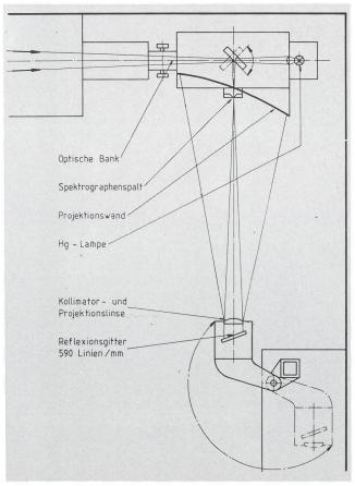
Bild I. Das Sonnenlicht wird vom Objektiv, weit links ausserhalb des Bildes, auf den Spektrographenspalt geworfen. Von dort geht das konvergierende Lichtbündel zur Kollimatorlinse und als nun paralleles Bündel zum Reflexionsgitter. Das gestreute Licht des Spaltes geht nochmals durch die selbe Linse, die nun als Projektionslinse dient. Der Spalt wird anschliessend auf der Projektionswand entsprechend den Wellenlängen mehrfach abgebildet.
