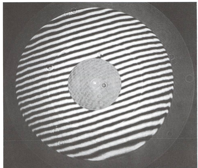
Interferogramm (optische Qualitätsprüfung des NTT-Hauptspiegels) Carl Zeiss/Archiv Städeli
