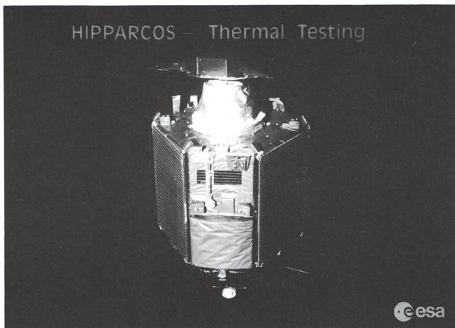
Die Flugeinheit des europäischen Astrometrie Satelliten Hipparcos im Testraum der ESTEC (European Space and Technology Center), nach dem Weltraumsimulationstest. Unter der Goldfolienisolationsmatt ist das Teleskopsystem untergebracht.
