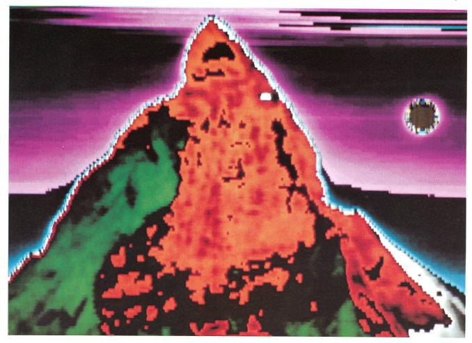
Abb. I: Das Matterhorn bei 90 GHz oder einer Wellenlänge von ca. 3 mm, kartographiert in einer 4stündigen Aufnahme mit dem Kontinuumsempfangssystem des 3-m-Radioteleskops (M. Miller). Auf der durch den Rechner eingefärbten Reproduktion erkennt man im Vergleich zum optischen Bild, dass Schnee- und Gletscherflächen den kalten Himmel reflektieren und daher kälter erscheinen (-120°C) als der nackte Fels
