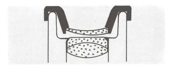
Abb. 2: Vorschlag für Aufsteckfassung eines Korrekturprismas.
