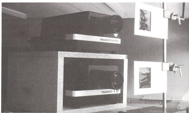
Abb. 2: Aufstellung der Projektoren für die Stereo-Projektion. Die Polarisationsfilter sind in Karton gefasst und am Stativen so befestigt, dass sie im Strahlengang liegen. Die Projektoren sollten lichtstark sein und möglichst identische Objekte aufweisen. Hier Pradovit 2500 mit Teleobjektiv 200 mm.
