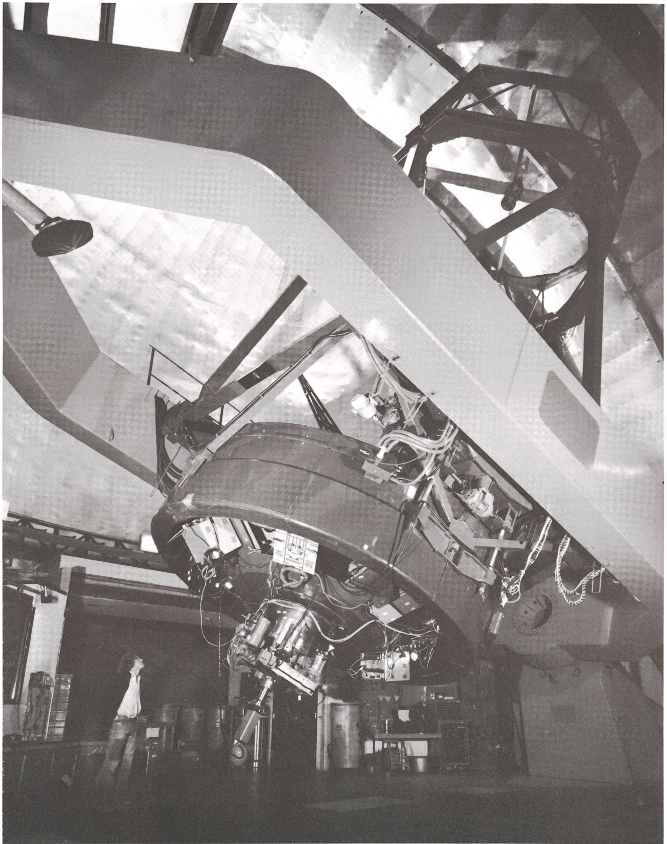
3) UKIRT mit 3,8 m Durchmesser das grösste Infrarot-Teleskop der Welt
