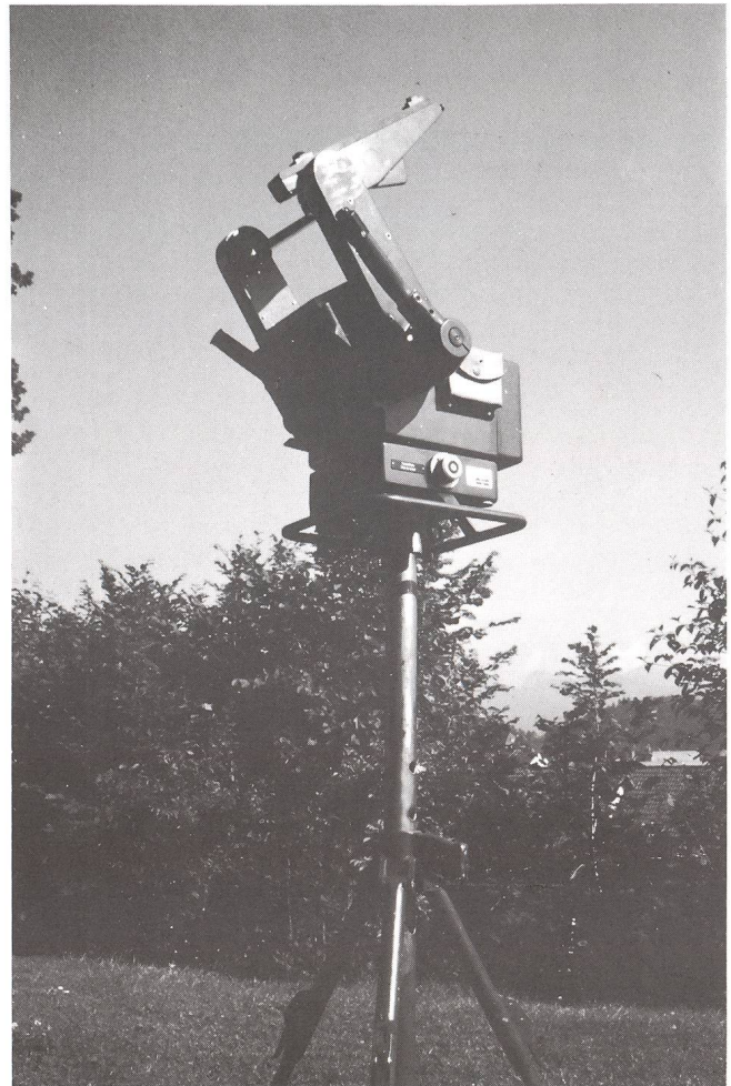
Abb. 2: Stativ mit Richtaufsatz, der eine azimutale Montierung bildet. Der oberste Teil kann als Visiereinrichtung dienen oder ein optisches Gerät (Feldstecher, Teleskop) aufnehmen. Bewegung und Nachführung an den seitlichen Handgriffen, Fixierung in Höhe und Seite durch Drehknöpfe.
