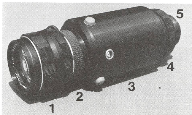
7) L'intensificateur en version lunette de vision nocturne, pour l'observation générale. L'image retournée provenant de l'objectif est remise à l'endroit par le tube électronique, ce qui est très pratique.
