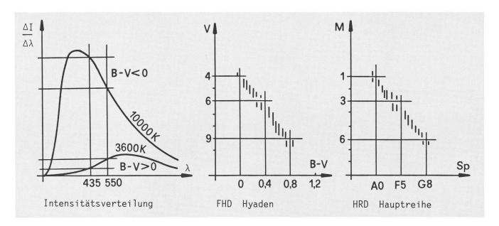
Den Farbenindices 0-0.4-0.8 entsprechen die Spektraltypen A0-F5-G8, so dass man aus dem Vergleich der Diagramme m-M = 3 abliest (was einer Entfernung von 40 pc entspricht). Damit werden die absoluten Helligkeiten der Riesen in den Hyaden bestimmbar.
