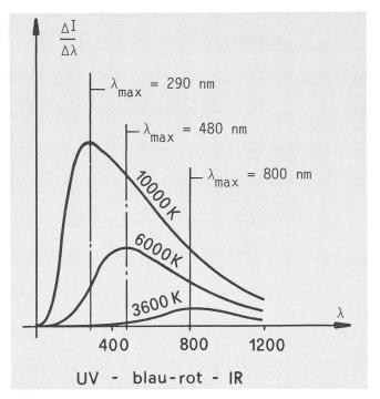
2) Die Intensitätsverteilung der Absorptionslinien. Für jedes Element gibt es eine charakteristische Temperatur, bei welcher die Intensität der zugehörigen Absorptionslinien maximal wird.
