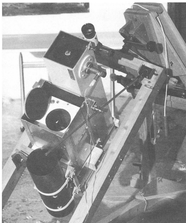
Le bloc-optique No 1: Sur l'équatoriale à berceau, de haut en bas: le télescope-guide 125/750, la chambre de Schmidt 125/200/210 et la chambre de Schmidt Célestron 5 de l'observatoire de Vevey.
