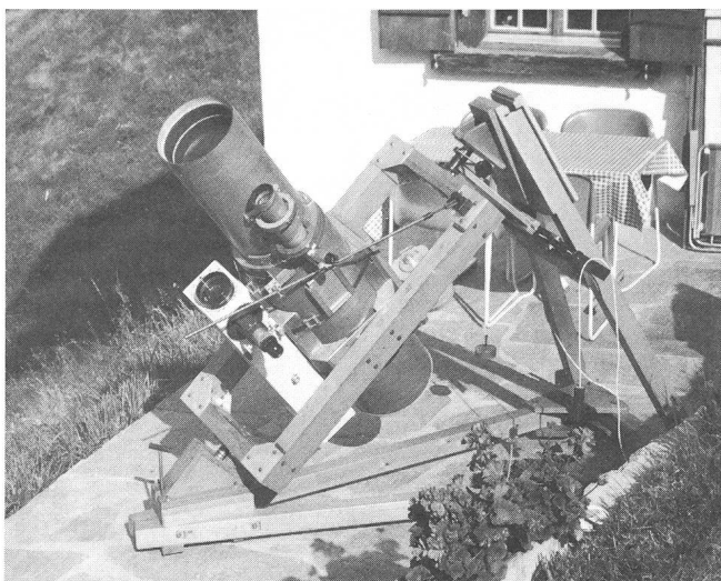
Le bloc-optique No 2: La chambre de Schmidt 220/250/600 et la lunette coudée 102/1600.
