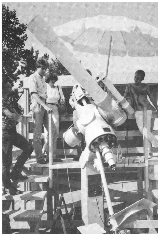
Abb. 2: Gesamtansicht des Zeiss-Coudé-Refraktors. In der Bildmitte der Bedienungsteil. Der nach unten gerichtete Fokus zeigt die Sonne in Projektion auf dem Bildschirm; oberer Fokus mit H-Alpha-Filter. Das kleine Rohr parallel zum Tubus ist das Sonnenleitrohr (Sonnenguiden).
