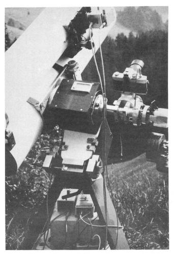
Abb. 9: Maksutow-Kamera mit 15 cm-Leitteleskop und beschriebener Nachführeinrichtung.
