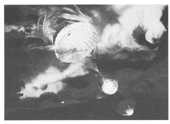
Abb. 3: Eintauchen der «Probe» in die dichte Jupiteratmosphäre. Der aerodynamische Hitzeschild ist durch die gewaltige Reibungshitze rotglühend. Die «Probe» wird noch zusätzlich durch einen grossen Fallschirm abgebremst. Sie soll ungefähr eine Stunde lang Daten aus der Atmosphäre des Riesenplaneten zum Orbiter übertragen. (Bild: MBB/Archiv SCHMIDT).
