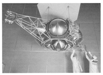
Abb. 4: Montagearbeiten am Galileo-Antriebsmodul in der Montagehalle der Firma MBB in Ottobrun. Zum erstenmal in der Geschichte der interplanetaren Raumfahrt wird ein Teil einer amerikanischen Raumsonde im Ausland gebaut. Das Antriebsmodul hat die Aufgabe, während des Hinfluges zum Jupiter Kurskorrekturen der Raumsonde auszuführen. Auch die Einbremsung zu einer langen Ellipse um den Jupiter ist Aufgabe dieses technischen Meisterwerkes. (Bild: MBB/Archiv SCHMIDT).
