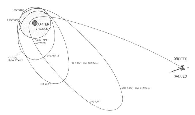
Abb. 2: Auf dieser Zeichnung sind die ersten vier Umläufe des Orbiters der Galileo-Raumsonde um den Jupiter eingezeichnet. Dabei wird der Orbiter bei seinen Begegnungen mit dem grössten Jupitermond Ganymed jeweils wieder auf eine neue Bahn umgelenkt. (Zeichnung: A. WALSER. ESA).
