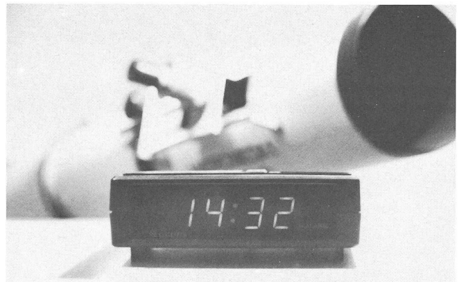
Abb. 2: Digitale Sternuhr mit Quarzbasis.
