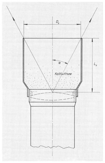
Abb. 2: Konventionell ausgeführte Taukappe. Das zu kleine  $L_s/D_{s-1}$ Verhältnis gibt einen grossen Raumwinkel frei, in den die Objektivoberfläche die gespeicherte Wärme abstrahlen kann und die Becherform führt zu einem gut isolierenden Kaltluftsee in der Taukappe, der einen Wärmeaustausch mit der wärmeren Umgebungsluft unter-
