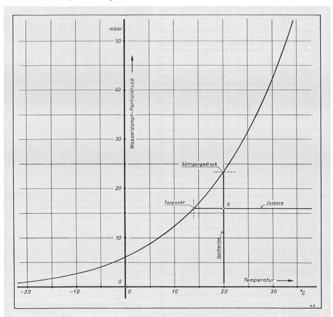
Abb. 1: pT-Diagramm des Wasserdampfes mit Sättigungskurve. Die Sättigungskurve begrenzt den Zustandsbereich des Wasserdampfes. Während im Feld rechts von der Kurve beliebige Zustände  $(p_X, T_X)$  möglich sind, sind bei Sättigung nur noch Zustandsänderungen längs der Kurve möglich. Der Siedepunkt des Wassers bei Atmosphärendruck ist ebenfalls ein Punkt dieser Kurve.
