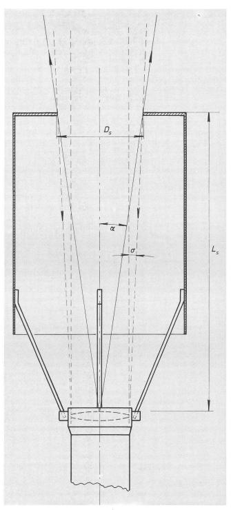
Abb. 3: Als Strahlungsschirm ausgebildete Taukappe. Das grosse  $L_S/D_S$ -Verhältnis gibt einen kleinen abstrahlenden Raumwinkel frei und über die offenen Zirkulationswege kann die über dem Taupunkt liegende Umgebungsluft alle Flächen gut umspülen.
