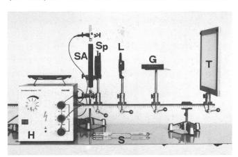
Abb. 1: Versuchsaufbau zur Erzeugung von Emissionsspektren mit Hilfe von Spektralröhren. Um auf dem Transparentschirm Streulicht zu vermeiden, empfiehlt es sich, um die Linse oder das Geradsichtprisma herum einen grossen schwarzen Karton anzubringen. G: Geradsichtprisma, H: Hochspannungsgerät, L: Linse (z.B. f=+15 cm), S: Spektralröhre, SA: Spektralröhre in Abdeckrohr, Sp: Spalt, T: Transparentschirm.
