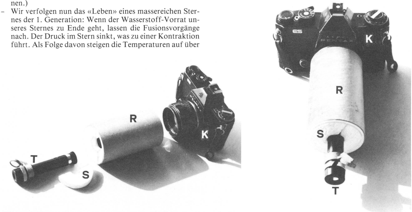
Abb. 2 a) und b): Einrichtung zur Photographie von Spektren, a) in Einzelteile zerlegt, b) zusammengesetzt. Das Kartonrohr mit dem Spektroskop wird über das Objektiv der Kamera gesteckt. Um das Taschenspektroskop im Rohr zu fixieren, klemmt man es mit zwei halben Ringen aus Styropor fest. K: Kamera mit Normaloptik, R: Rohr aus starkem Karton, wie es z.B. für den Versand von Postern verwendet wird, S: Styroporhalbringe, T: Taschenspektroskop.
