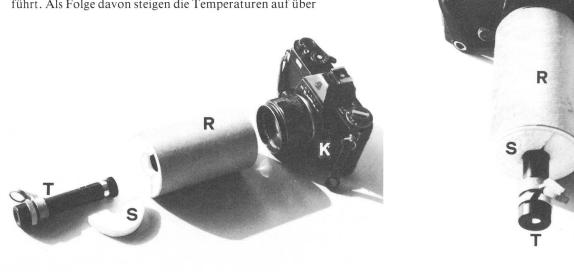
Abb. 2 a) und b): Einrichtung zur Photographie von Spektren, a) in Einzelteile zerlegt, b) zusammengesetzt. Das Kartonrohr mit dem Spektroskop wird über das Objektiv der Kamera gesteckt. Um das Taschenspektroskop im Rohr zu fixieren, klemmt man es mit zwei halben Ringen aus Styropor fest. K: Kamera mit Normaloptik, R: Rohr aus starkem Karton, wie es z.B. für den Versand von Postern verwendet wird, S: Styroporhalbringe, T: Taschenspektroskop.
