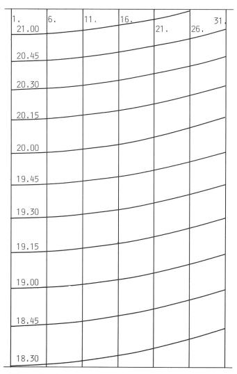
Abb. 7: Abendskala für das senkrechte Brettchen. Zur Vereinfachung ist die Morgenskala hier weggelassen. Die gebogenen Linien geben MESZ an. Abgelesen wird beim entsprechenden Datum. Die Daten bei den senkrechten Linien gelten für den Juli. Skala in natürlicher Grösse.
