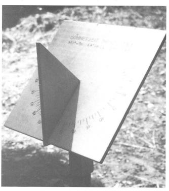
Abb. 2: Die Sonnenuhr zeigt 12 Uhr MESZ. Aber erst wenn der Schatten verschwindet (etwa in 1¾ Stunden), ist wahrer Mittag.
