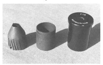
Abb. 2: Selbsthergestelltes Strichplatten-Okular. Der Teil links im Bild trägt oben die Meßskala. Er wird in das Röhrchen (Mitte) eingeschoben. Beide Teile zusammen passen in die Fassung des normalen Okulars (rechts).
