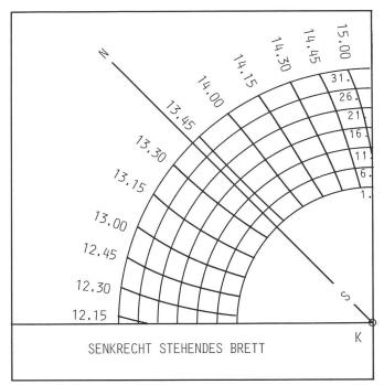
Abb. 8: Mittagsskala im Maßstab 1:1. Die senkrecht zur Papierebene stehende Kante (K) begrenzt den Schatten. Diese Schattengrenze zeigt während der Mittagszeit auf dieser Skala die MESZ an. Sie wird am 1. Juli auf dem innersten und am 31. Juli auf dem äussersten Kreisbogen abgelesen.
