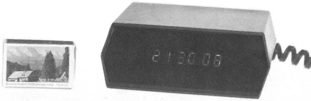
Abb. 2: Diese präzise Quarz-Sternzeituhr mit LED-Anzeige läuft am Netz, wobei eine eingebaute Batterie Netzausfälle überbrückt. Sie kostet 175.— Fr. und kann bezogen werden bei CHRISTIAN MONSTEIN, Wiesenstrasse 13, CH-8807 Freienbach. (Weitere technische Angaben dazu im Text).
