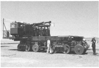
Abb. 8: Der Transporter zum Versetzen der Teleskope, selber 60 Tonnen schwer.
