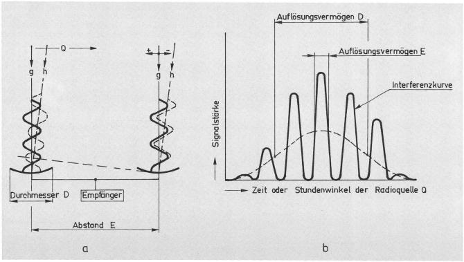
Abb. 3: Das Interferometer.
