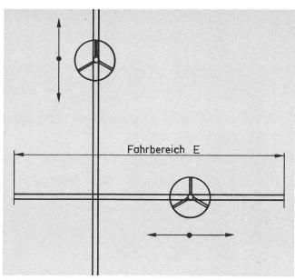
Abb. 4: Antennen-Synthese. Durch mehrfaches Verstellen von zwei Teleskopen werden verschiedene Interferometer gebildet. Die jeweiligen Messresultate werden nachträglich zusammen verarbeitet und ergeben ein Auflösungsvermögen, das einem Spiegel mit Durchmesser E entspricht.
