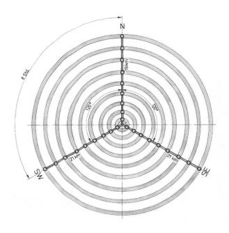
Abb. 5: Die Anordnung des VLA. Drei Schienenstränge von 19 km, 21 km und 21 km Länge sind unter 120° angeordnet. Auf jedem Strang sitzen 9 Radioteleskope, insgesamt also 27.
