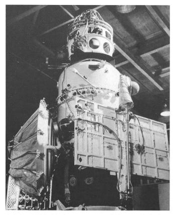
Auf diesem Bild erkennt man eine sovjetische Raumsonde des Typs «Venera». Die dunkle Kugel unten ist das Landegerät. Der obere Teil fliegt an der Venus vorbei und empfängt die Daten des Landers, speichert diese, und überträgt sie nachher zur Erde. Photo: Novosti
