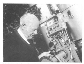
Jakob Lienhard an seinen Instrumenten. An Zusatzgeräten erkennt man u.a. eine Uhr, ein Milliampere-Meter für das Photometer und die Bedienungsknöpfe der Hellfeldbeleuchtung.
