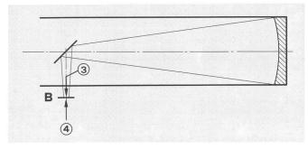
Abb. 3: Der Fangspiegel im Newton-Teleskop lenkt den Strahlenkegel um, das vom Hauptspiegel erzeugte Bild liegt jetzt in der Ebene B, wo es mit dem Okular betrachtet werden kann.
