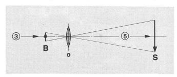
Abb. 4: Okularprojektion. Das Bild in der Ebene B wird mit Hilfe des Okulars O auf den Schirm S projiziert.
