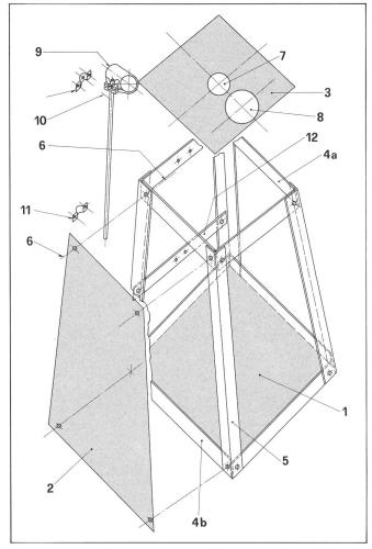
Abb. 2: Konstruktionszeichnung für Sonnenbild-Projektionskasten.
