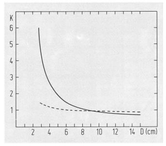
Abb. 3: Abhängigkeit des k-Faktors der Sonnenflecken-Relativzahl vom Objektivdurchmesser des Beobachtungsinstrumentes nach<sup>9</sup>), aufgeteilt nach der Abhängigkeit des k-Faktors für Gruppen (unterbrochene Kurve) und für Einzelflecken (durchgezogene Kurve). Die Kurven geben nur ungefähre Werte für k an, in der Praxis können erhebliche Abweichungen auftreten.
