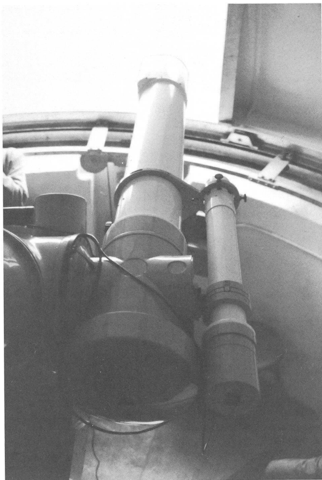
Abb. 3: 15 cm-Coudé-Refraktor der Firma Zeiss. Rechts das Sonnenleitrohr.
