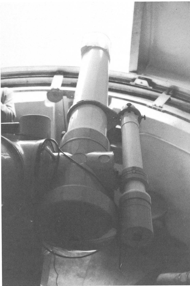
Abb. 3: 15 cm-Coudé-Refraktor der Firma Zeiss. Rechts das Sonnenleitrohr.
