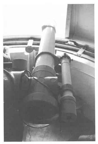
Abb. 3: 15 cm-Coudé-Refraktor der Firma Zeiss. Rechts das Sonnenleitrohr.
