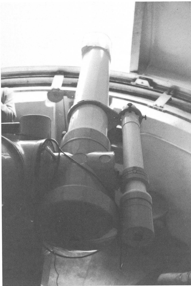
Abb. 3: 15 cm-Coudé-Refraktor der Firma Zeiss. Rechts das Sonnenleitrohr.
