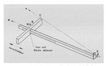
Abb. 1: Jakobstab. Für das Visieren über die Nägel A, B, C zusammen mit Nagel M werden drei verschiedene Skalen verwendet. Diese sind auf drei verschiedenen Flächen des langen Stabs angebracht, je eine Skala links, oben und rechts. Z = Auge des Beobachters.
