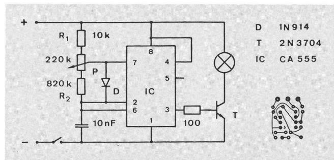
Nicht zu vergessen ist die Unterbrechung der Kontaktlamelle von der Lampe zum Ein-Ausschalter. Diese wird ersetzt durch eine Verbindung Lampe-Kollektor von T. Lässt man die Verbindung hingegen bestehen, so liegt der Ein-Ausschalter parallel zum Transistor. Damit lässt er sich zum schnellen Umschalten «eingestellte Helligkeit—maximale Helligkeit» gebrauchen. Zum Abschalten der Schaltung benötigt man nun aber einen zusätzlichen Schalter oder aber man entfernt die Batterie.
