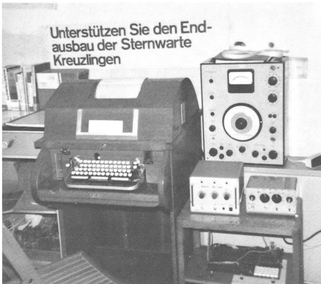
Abb. 5: Digitale Ausgabeeinheit bestehend aus: Fernschreiber LORENZ 15, Analog/Digital — Wandler, Fernschreibkonverter, Mikroprozessorplatte INTEL 8085. Rechts aussen Präzisions-NF-Generator.
