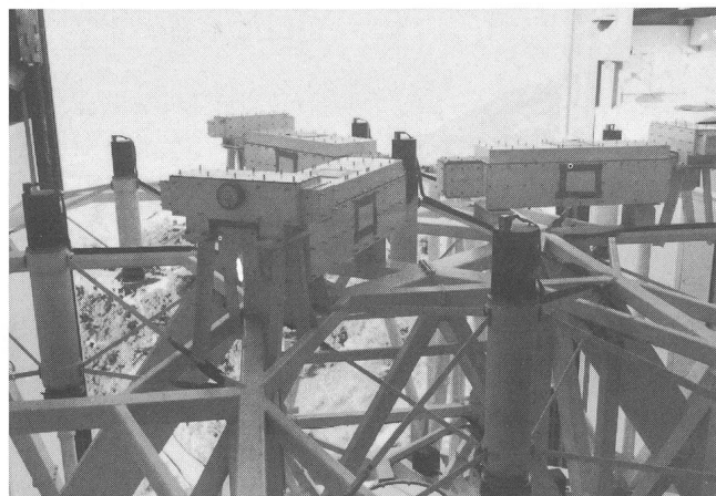
Abb. 7: Blick auf das Vorderende des MMT mit den 3 Periskopen und 5 der 6 Sekundärspiegelhalter. In der Mitte unten ist teilweise der Hauptspiegel des Nachführinstruments zu sehen, oben der dazugehörige Sekundärspiegelhalter.
