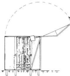
Wände, Türe und Dach in Stahlblech hellgrün/beige einbrennlackiert, Boden in Holz, Dach umklappbar zum Öffnen und Schliessen von Hand, verriegelbar. Einschliesslich separater fundiertes Stahlrohr für Instrumente. Abmessungen: Breite 1,8 m, Länge 2,3 m und Höhe 1,95 m.
