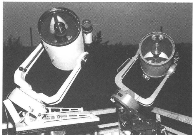
Bei der Fokalfotographie, ob nun mit zwei Metern Brennweite oder mit der Fokalreduzierlinse bei einem Meter Brennweite, zeigen die Photos, die mit beiden Teleskopen gemacht worden sind, keinen Unterschied. Bei beiden war die Auflösung der Photos gleich.
