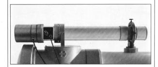
Beobachten und registrieren Sie die Sonne langfristig? Dann ist das Sonnenleitrohr von Zeiss ideal für Sie! Es führt Ihr Beobachtungsinstrument automatisch nach. Genau!
