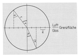
Abb.: 1: Ableitung der Brechungskonstante für Luft-Gas am Einheitskreis (r = Radius; e = Einheit).
