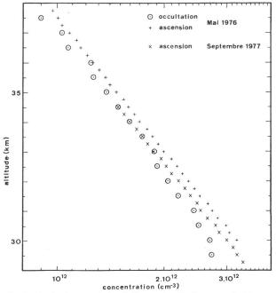
Fig. 9: Distributions verticales de l'ozone (molécules par cm³) obtenues par sondage vertical et par la technique d'occultation.
