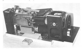
Photo 2: Photomètre U. V. stellaire à huit couleurs composé d'un télescope de 15 cm (en arrière), d'un pointeur d'étoile (au-dessus) et d'une caméra T. V. (en dessous).
