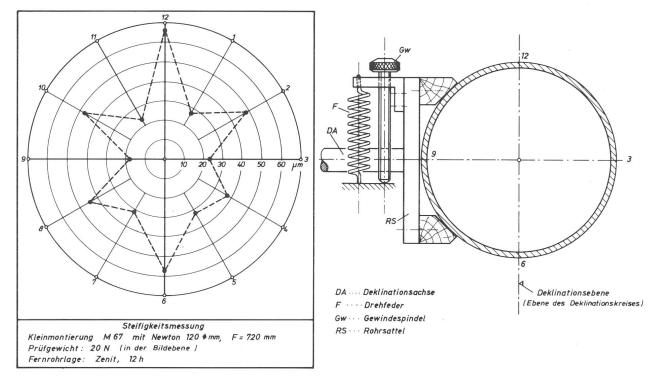
Abb. 4.2 Polardiagramm der Auslenkungen bei der Messung der Steifigkeit an einer Montierung
