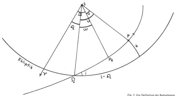
Fig. 3 Zur Definition der Bahnelemente.
