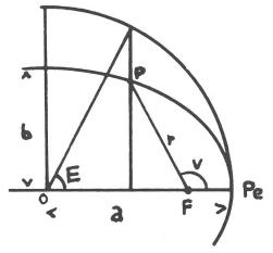
Fig. 2 Zur Ableitung der excentrischen Anomalie E.
