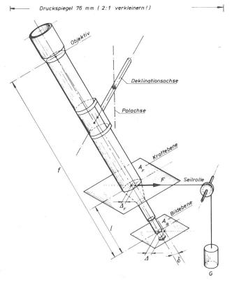
Abb. 4.1: Messung der Systemsteifigkeit an einem Refraktor. Dazu lässt man eine bekannte Prüfkraft F auf das Rohr einwirken und misst mit der Teleskopoptik die Winkelauslenkung  $\delta$  oder die lineare Auslenkung  $\Delta$ . Die Prüfkraft muss in einer zur Bildebene  $A_B$  parallelen Ebene  $A_B$  liegen und wird über eine Schnur und ein kleines Seilröllchen aufgebracht. Die Umrechnung von  $\Delta$  auf  $\Delta_B$  erfolgt nach:
